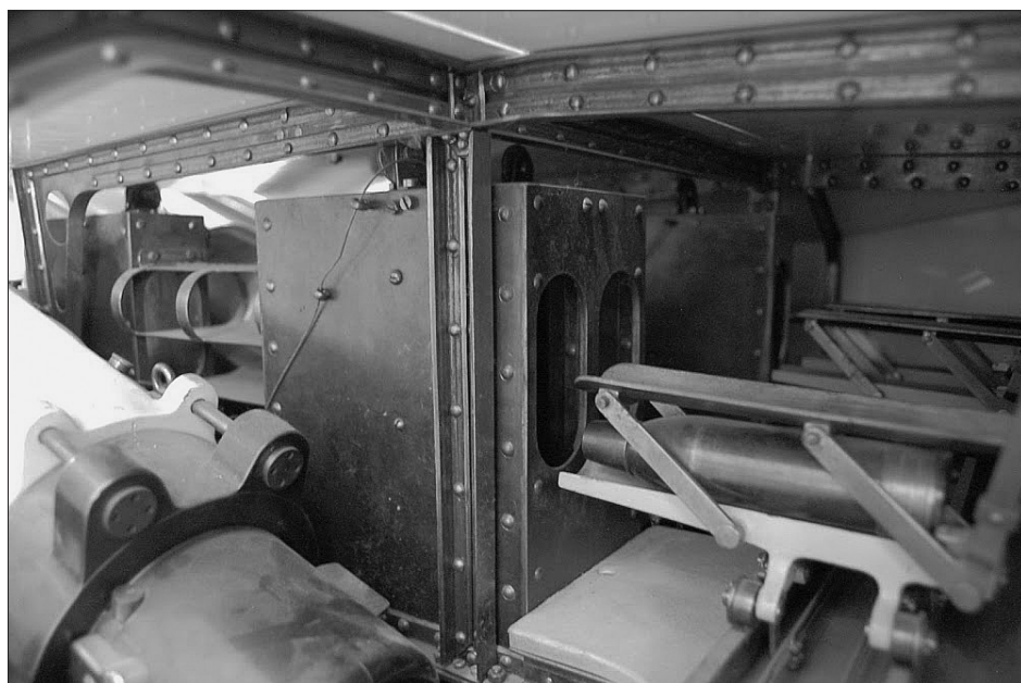
34 kép. A Škoda által készített hármás lövegtorony-modell részlete. Jól láthatók a lőszerfelvonók aknáí és a kábelekkel mozgatott töltőkocsik. A modell a bécsi Heeresgeschichtliches Museumban látható
