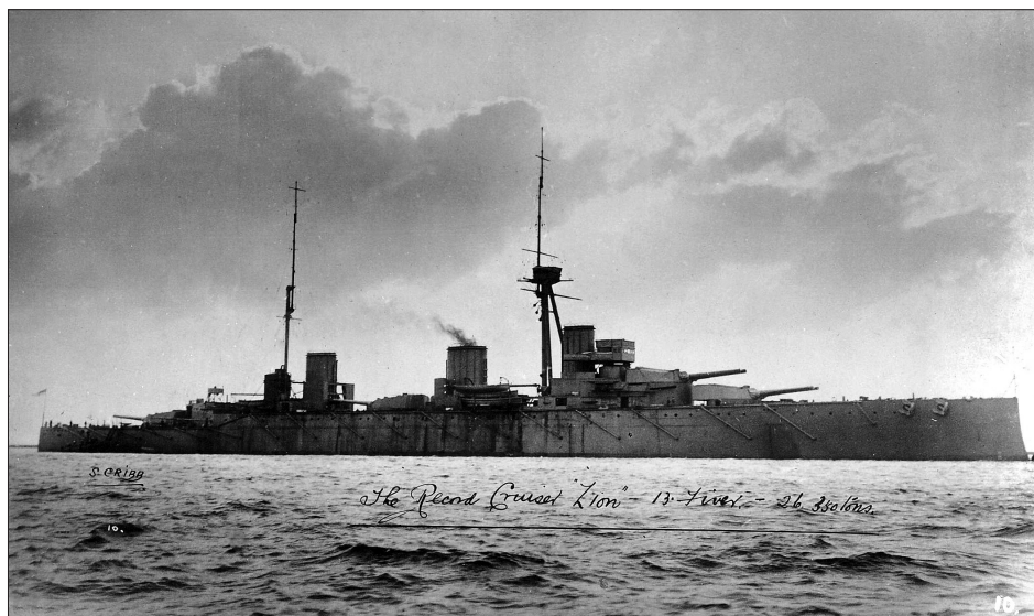
8. kép. A LION brit csatacirkáló, a „remek macskák” első egysége 1912 januárjában. Még végleges szolgálatba állítása előtt új, az első kémény előtt lévő árbocot kapott. Erre azért volt szükség, mert a képen látható elrendezésben a kiáramló forró füstgázok lehetetlenné tették az árbocon lévő megfigyelő állásban való tartózkodást
