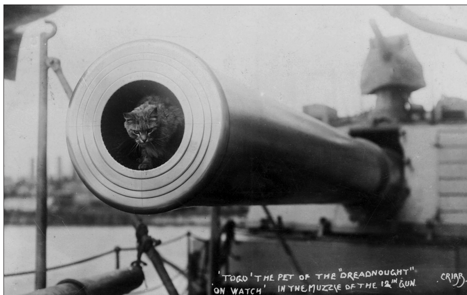
13. kép. A DREADNOUGHT egyik 30,5 cm L/45 lövege. Jól látszik az ágyúcső koncentrikus részekből álló „épített” szerkezete, illetve a huzagolás. A csőben Togo, a hajó kabalamacskája
